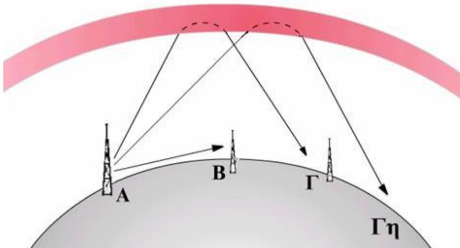
Συμπερασματικά, συγκεντρώνοντας στο σχήμα 4.2.9 τα φαινόμενα διάδοσης του κύματος εδάφους και του ιονοσφαιρικού κύματος ή κύματος χώρου οδηγούμαστε σε δύο σημαντικές παρατηρήσεις:
