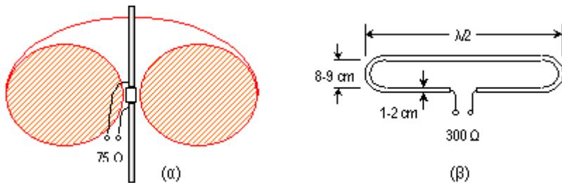
**Σχήμα 6-18.** (a) Κατακόρυφη κεραία – δίπολο με διάγραμμα κατευθυντικότητας και (b) αναδιπλωμένο δίπολο
