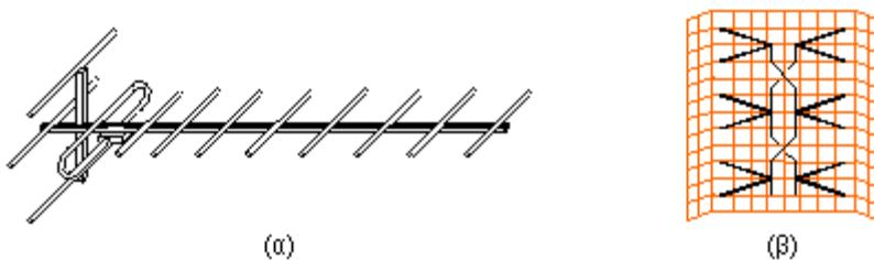
*Σχήμα 6-27. Κεραίες τηλεόρασης: (α) Yagi και (β) μετωπική*
