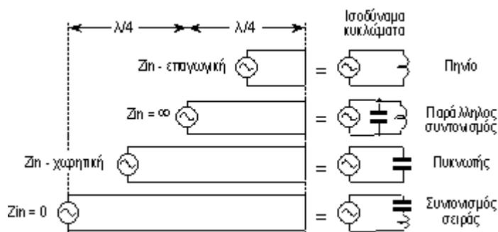
*Σχήμα 6-6. Βραχυκυκλωμένες γραμμές και τα ισοδύναμα κυκλώματά τους*
