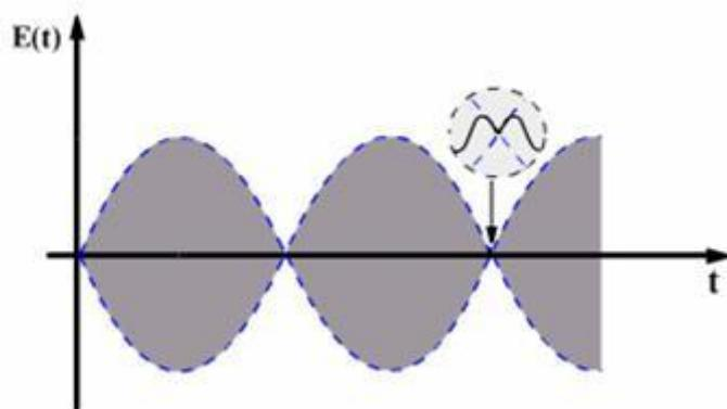
Δηλαδή, το σήμα διαμόρφωσης  $s(t)$  μόνο του παίζει το ρόλο του πλάτους του φέροντος σήματος. Η εικόνα του σήματος στον παλμογράφο δίνεται στο σχήμα 3.8.9.
