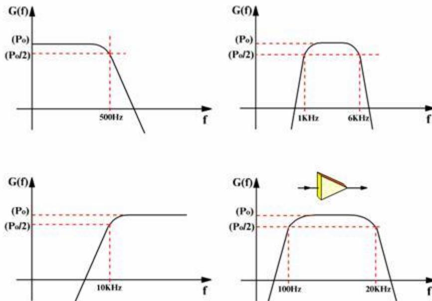
Για να μπορούμε να εκτιμήσουμε το εύρος ζώνης λειτουργίας ενός φίλτρου, ενός ενισχυτή και γενικότερα ενός συστήματος έχουμε όλοι αποδεχτεί ότι τα όρια της ζώνης είναι οι συγχρόνητες στις οποίες η ισχύς του σήματος στην έξοδο υποβιβάζεται κατά 3 dB, δηλαδή διαιρείται δια δύο, σε σχέση με την ισχύ που έχει το σήμα στις συχνότητες λειτουργίας. Αυτά τα όρια ονομάζονται 'συγχρόνητες αποκοπής' (σχήμα 3.5.8).
