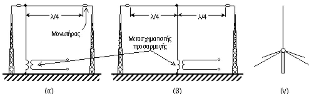
Σχήμα 6-17. Κεραίες τύπου Γ (α), T (β), και Ground Plane
