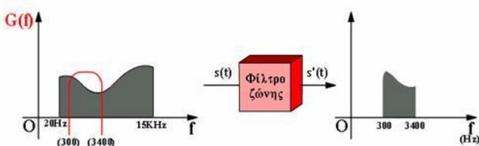
Στο σχήμα 3.5.3 που ακολουθεί χρησιμοποιούμε ένα φίλτρο, για να περιορίσουμε τη ζώνη του φάσματος της ομιλίας και να δημιουργήσουμε το τηλεφωνικό σήμα.
