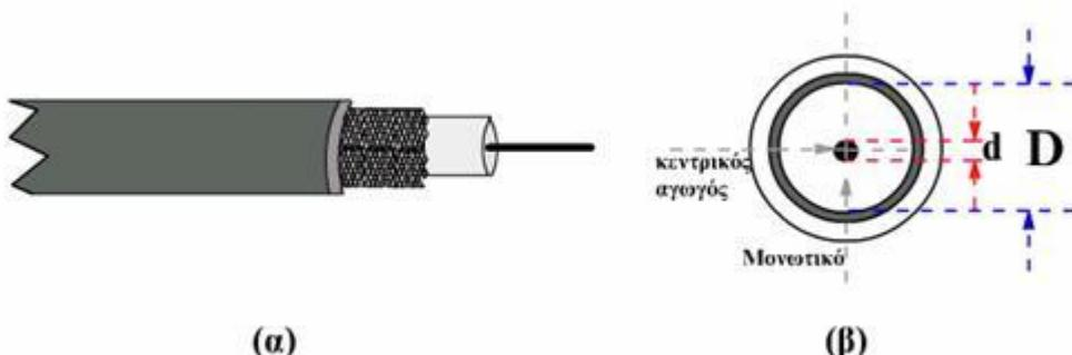
Η συνηθέστερα χρησιμοποιούμενη γραμμή μεταφοράς είναι το ομοαξονικό καλώδιο. Η κυλινδρική μορφή του και η διατομή του φαίνονται στο σχήμα 4.5.4.
