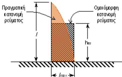
Σχήμα 6-13. Γεωμετρικό ( $l$ ) και ενεργό ( $h$ ) ύψος κεραίας
