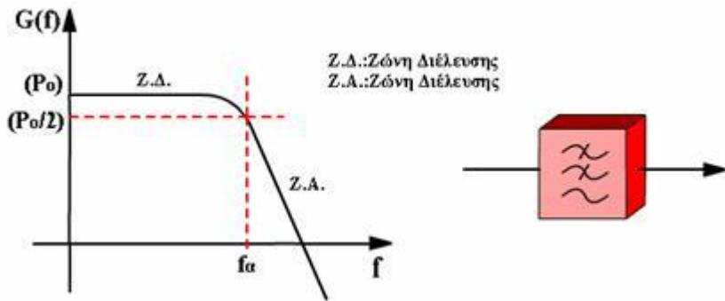
**Χαμηλοδιαβατό ή χαμηλοπερατό φίλτρο.** Είναι αυτό που επιλεκτικά αφήνει να διέλθει το χαμηλό τμήμα συχνοτήτων. Η λειτουργία του και το σύμβολο του φαίνονται στο σχήμα 3.5.4. του.
