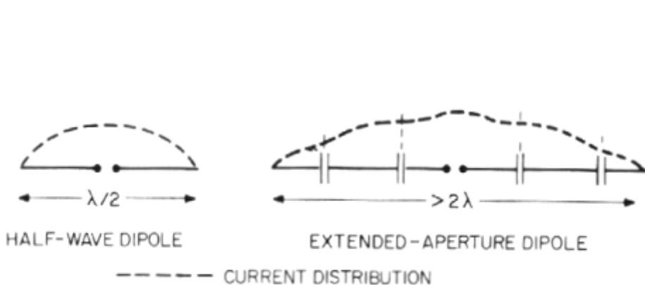
Half - wave dipole = Δίπολο  $\lambda/2$  , Extended - aperture dipole= Δίπολο εκτεταμένου ανοίγματος , Current distribution = κατανομή ρεύματος.
