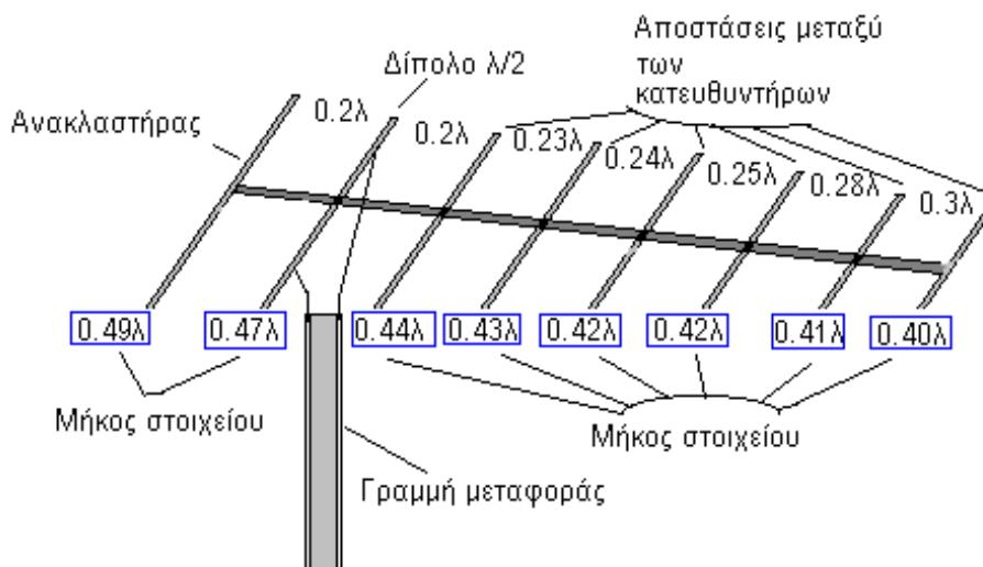
Σχήμα 5.44. Κεραία Yagi.
