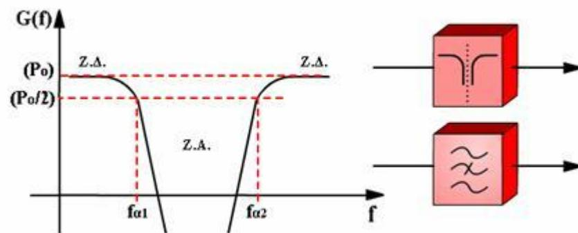
**Φίλτρο απόρριψης ζώνης.** Είναι αυτό που δεν αφήνει να διέλθει συγκεκριμένο μεσαίο τμήμα του φάσματος ενός σήματος. Η λειτουργία και το σύμβολο του φαίνονται στο σχήμα
