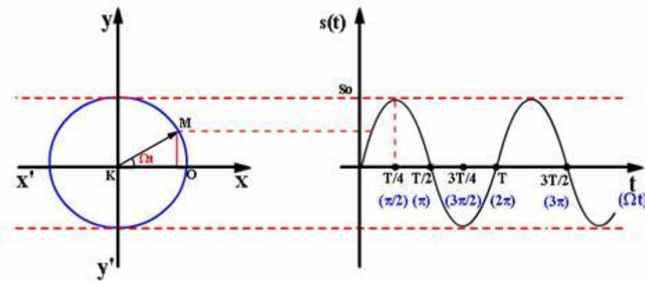
Το απλούστερο περιοδικό σήμα είναι το **ημιτονικό σήμα**, που το έχουμε γνωρίσει και από τα μαθήματα ηλεκτρονικής και ηλεκτροτεχνίας. Είναι το βασικότερο σήμα στις τηλεπικοινωνίες και το χρησιμοποιούμε πάντοτε σαν σήμα αναφοράς, για να περιγράψουμε και να χαρακτηρίσουμε όλα τα άλλα ηλεκτρικά σήματα. Η εικόνα του ημιτονικού σήματος στον παλμογράφο είναι αυτή του σχήματος 3.3.5.
