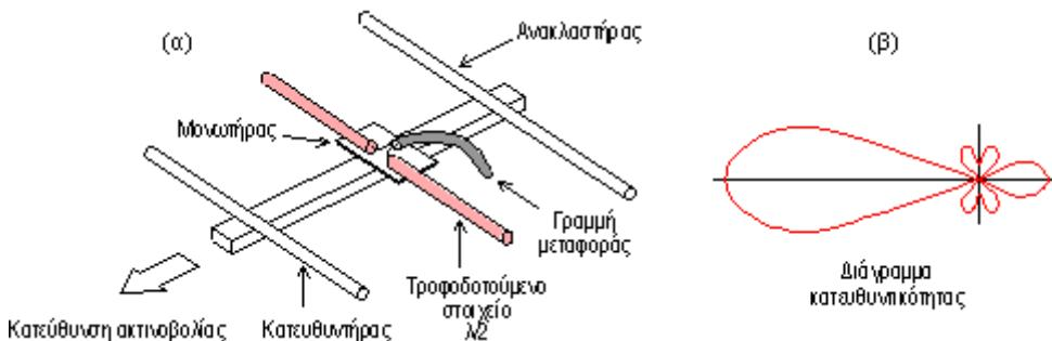
**Σχήμα 6-19.** Κεραία Yagi (a) και διάγραμμα κατευθυντικότητας (b) της κεραίας
