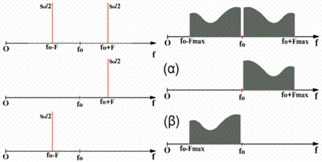
Αυτό σημαίνει ότι στη ζώνη που καταλαμβάνει μια εκπομπή με διαμόρφωση AM τώρα μπορούν να υπάρξουν δύο εκπομπές SSB (σχήμα 3.8.12).
