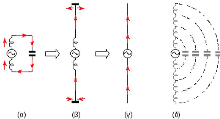
**Σχήμα 6-10. Σχέση μεταξύ κεραίας και κυκλώματος συντονισμού**
